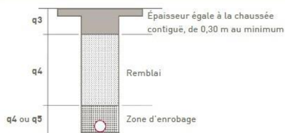
Tranchée sous accotements
